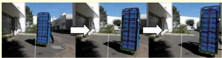
4輪旋回（自在）タイプを傾いた路面で直進させようしている様子
